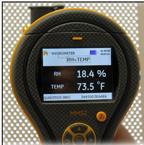
Figur 4: MMS2 som hygrometer
